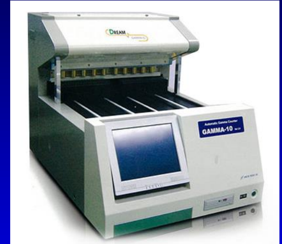
Μετρητής γ τύπου φρεατίου (well counter) για ταυτόχρονη μέτρηση πολλών δειγμάτων
